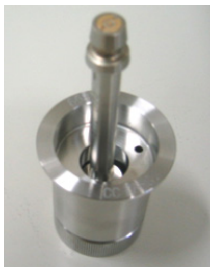
(b) 測定治具（共軸二重円筒型）
