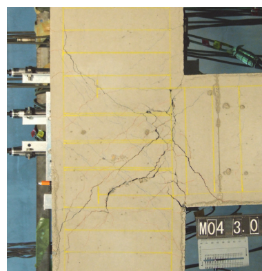
層間変形角 3.0%時
