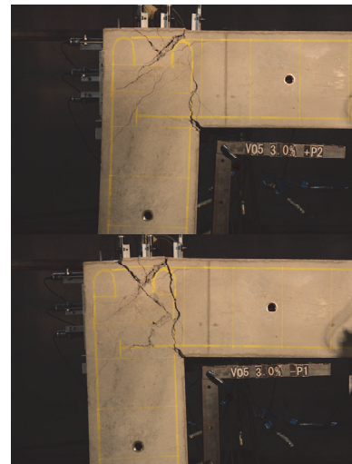
層間変形角 3.0%時
