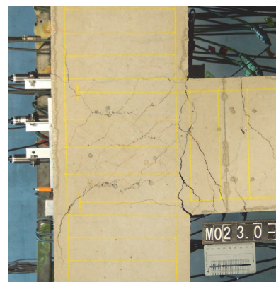
層間変形角 3.0%時
