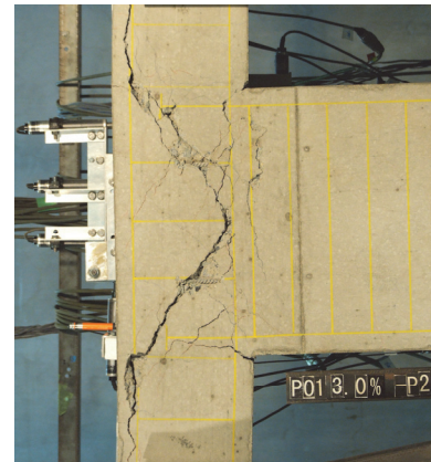
層間変形角 3.0%時
