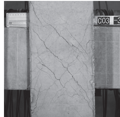
層間変形角 3.0%時
