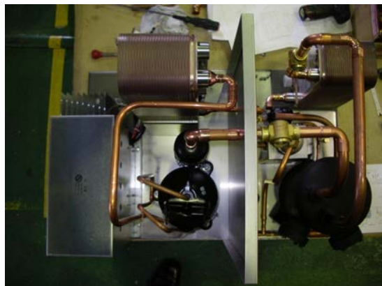
図 5.1.4-2 配管製作と仮組みの外観写真
