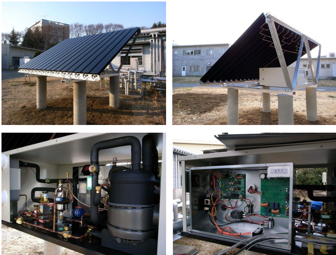
図 4.1.1-1 太陽空気熱源ヒートポンプ試作機の写真
