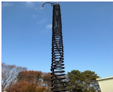
図 7.1.2-1 ヘリカルコイル型地中熱交換器の写真 7.3) 図 7.1.2-2 ヘアピンカーブ型地中熱交換器の写真 7.3)
