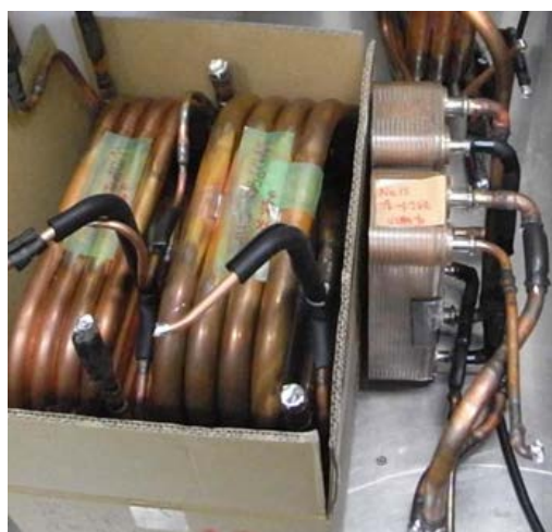
図 6.1.2-3 冷媒/水 熱交換器 (左：二重管式, 右：プレート式)
