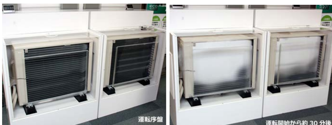
図 2.2.1-5 室外機の着霜の様子（実験装置） 2.10)
