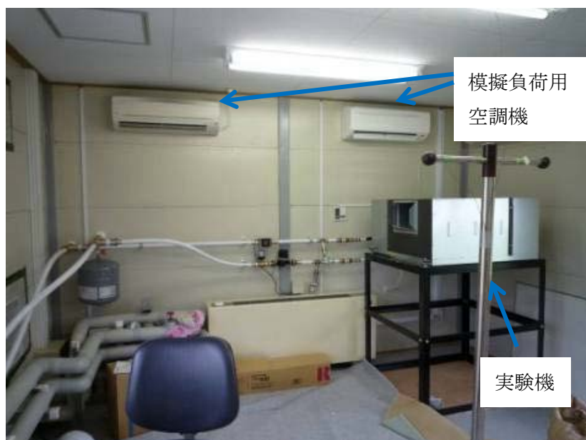
図 6.2.2-2 実験室の内観写真（模擬負荷用空調機と実験機）
