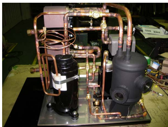
図 5.1.3-7 サイドグラスの設置状況写真
