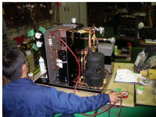
図 5.1.4-4 冷媒充填と検圧
