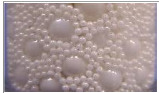
二種類の粒子からなる混合粒子系。(体積比は 1mm φ : 5mm φ = 3 : 7)
