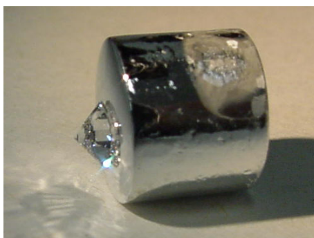
Figure 2.2 Ar-FAB 30 s 照射し接合したダイヤモンドと Al の接合試料
