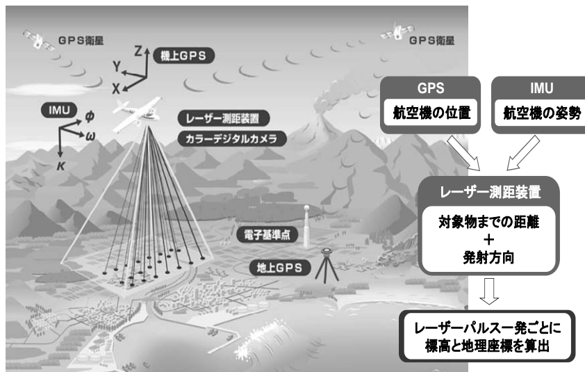
図VI-1 航空レーザ計測のしくみ
