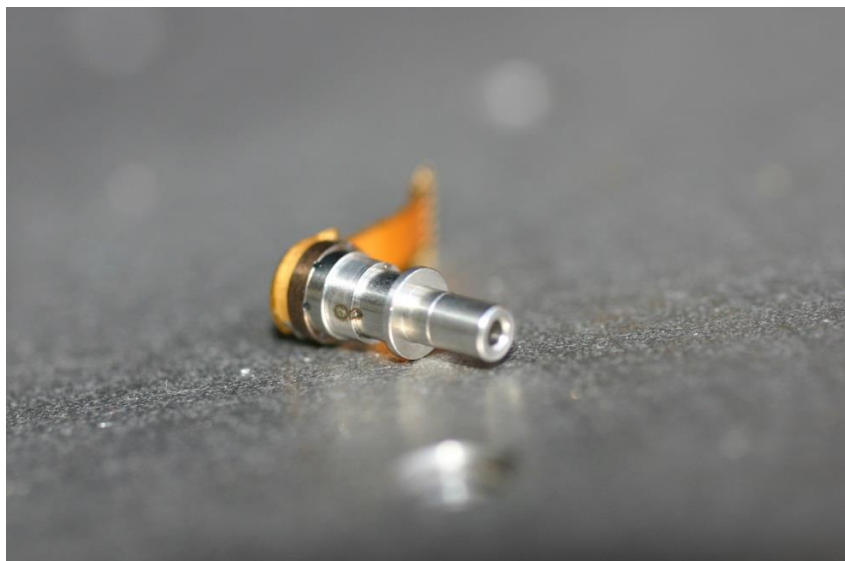
図 7-1 25 Gbit/s 動作に向けた反転型 APD を実装した 1ch CAN 型光レシーバ
