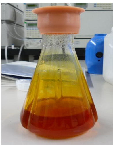
図 2-5 : 培養後期の A. ferrooxidans の振盪培養フラスコ 上部にシリコセンがしてある。側面の溝は振盪によって培地に対する 通気量を増加させ、効率的に空気中の O_2 、 CO_2 を培地に取り込む。 赤色は鉄イオンが酸化して生成している。下部に赤褐色の沈殿が生成 している。
