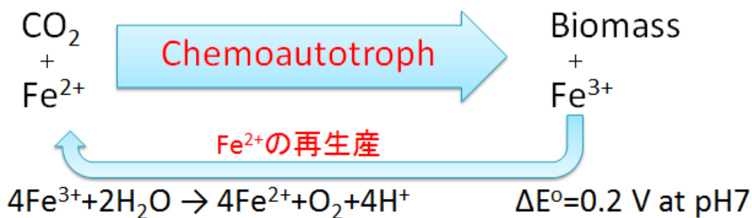
図 5-3 鉄酸化化学独立細菌を用いたバイオマス生産の模式図
