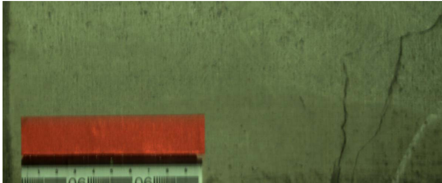
図 4.31. オートフォーカス機能を使い，CoaXPress の通信帯域を 3.125Gbps として，時速 70km で走行中にモーションブラー補償及びプリアンファシス技術有りて撮像した画像
