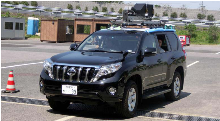
図 4.12. 車両にモーションブラー補償装置を搭載した様子。
