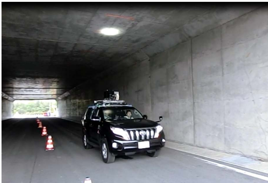
図 4.15. カルパートボックスにおける HSV システム走行中の様子
