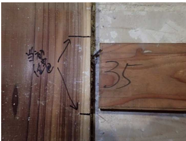
図 4-115 解体後 幅木左端部の破壊状況〔胴付斜め釘 1 本打ち〕
