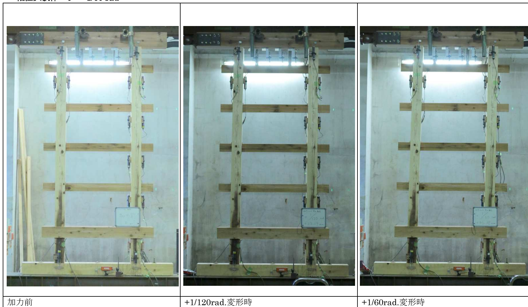
図 4-44 軸組試験体 0 - +1/60rad.
