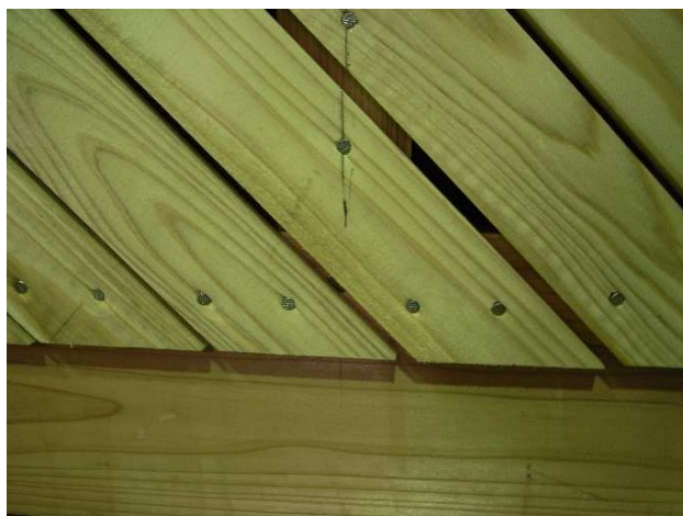
+1/45rad. 端部の釘の軸方向変形
