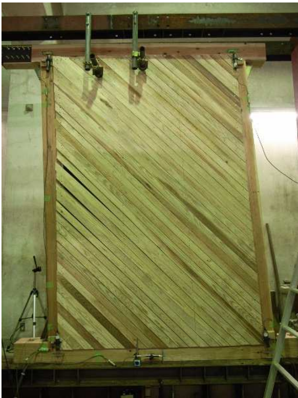
-1/20rad. 左上釘の引き抜け破壊 同詳細 図 4-153 斜め木摺壁 破壊の進行
