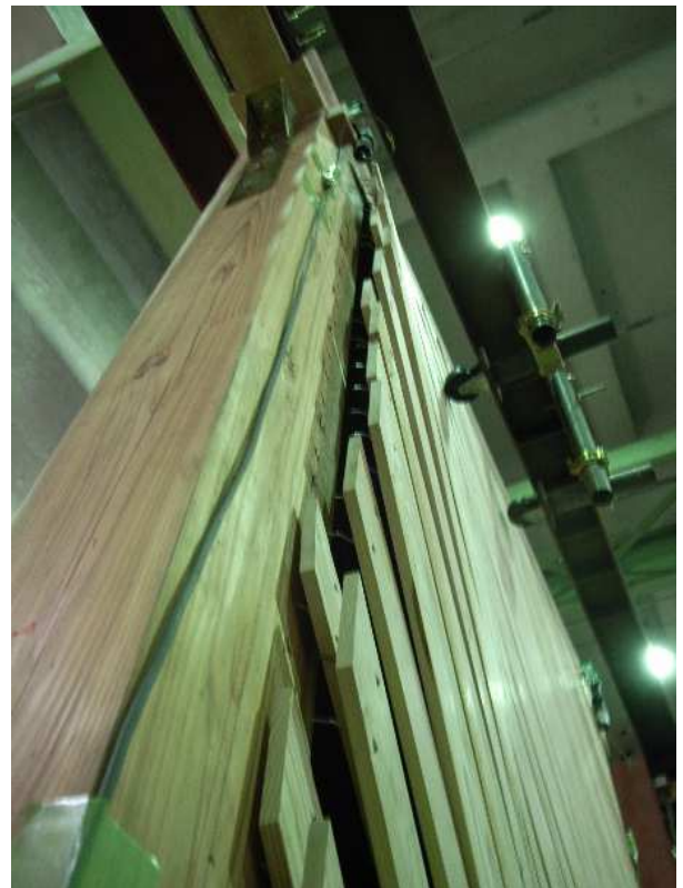
+1/20rad. 木摺端部釘の降伏，浮き上り
