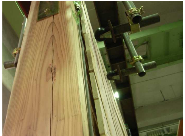
+1/20rad. 木摺端部釘の降伏，浮き上り
