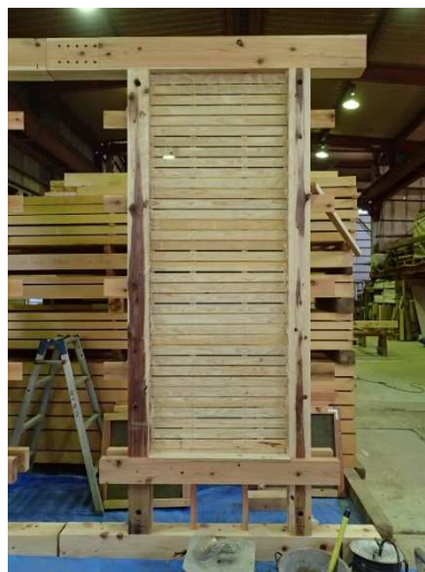
図 3-10 木摺壁の種類と端部の釘打ちの形式：大壁水平木摺，大壁斜め木摺，真壁水平木摺
