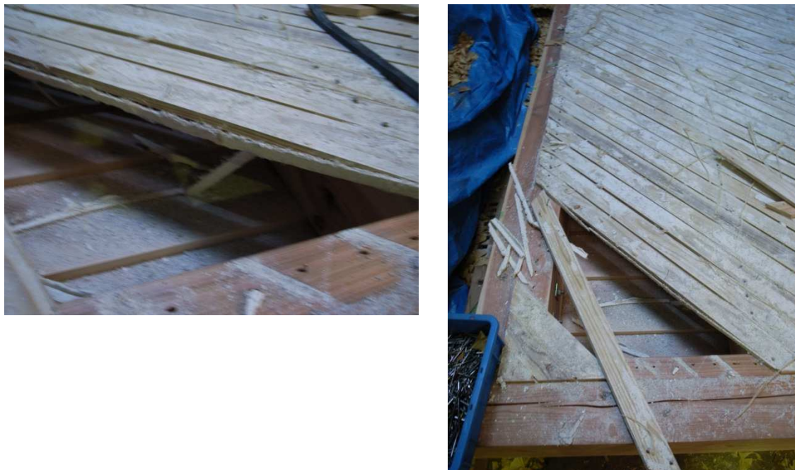
図 6-30 斜め木摺漆喰壁 試験後解体写真 木摺空きへの漆喰の状態
