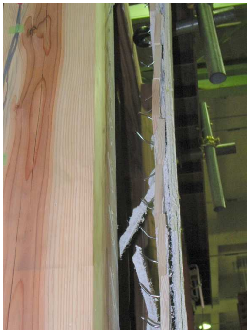
破壊：+1/20rad. 釘接合部
