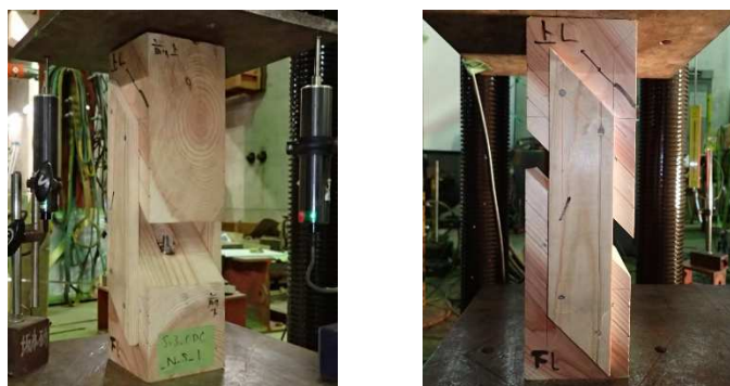
図 5-57 Sr3 ODC_N_S_1 試験体 破壊の進行 下部釘の引き抜け
