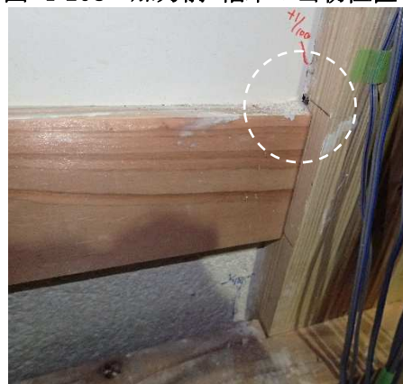
図 4-109 幅木右端部の垂下+1/100rad. (左図), +1/60rad. [最大荷重時] (右図)
