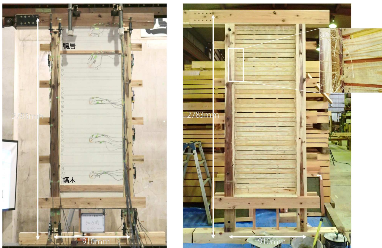
図 6-1 解析モデルの仕様を持つ真壁木摺漆喰壁（漆喰施工後，施工前）
