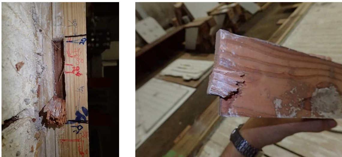
図 4-114 解体後の幅木右端部の破壊状況
