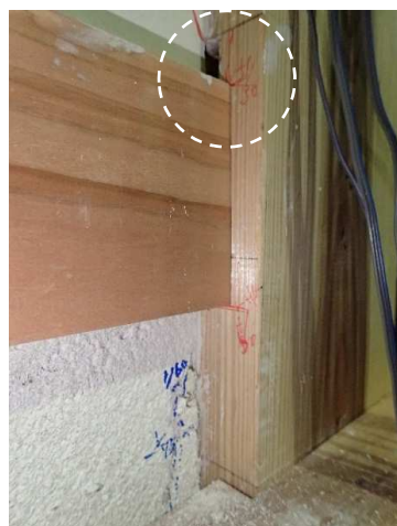
図 4-112 +1/30\text{rad.} 幅木右端部の垂下の進行 (約 20\text{mm} 垂下)
