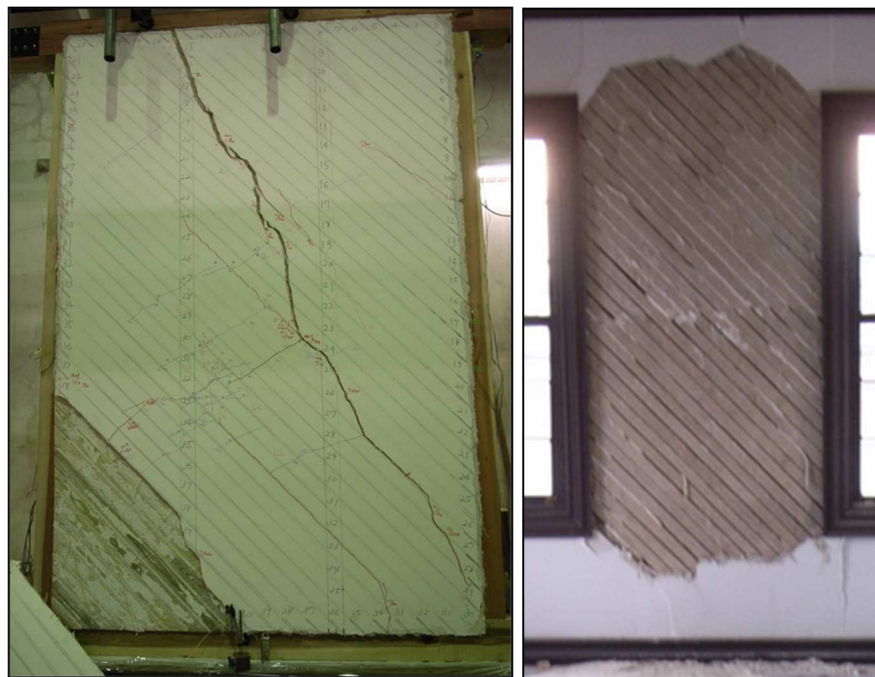
図 4-161 斜め木摺の破壊性状の比較 試験体4 終局状態（左図）、旧伊達郡役所2階西側被災後の漆喰剥落（右図）
