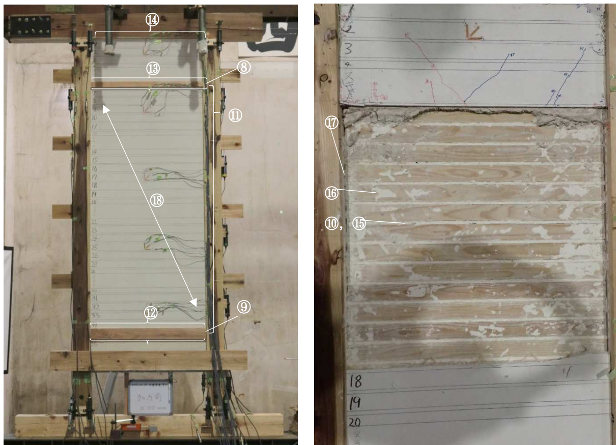
図 4-100 木摺漆喰壁の漆喰との接合部・接触部による抵抗部位
