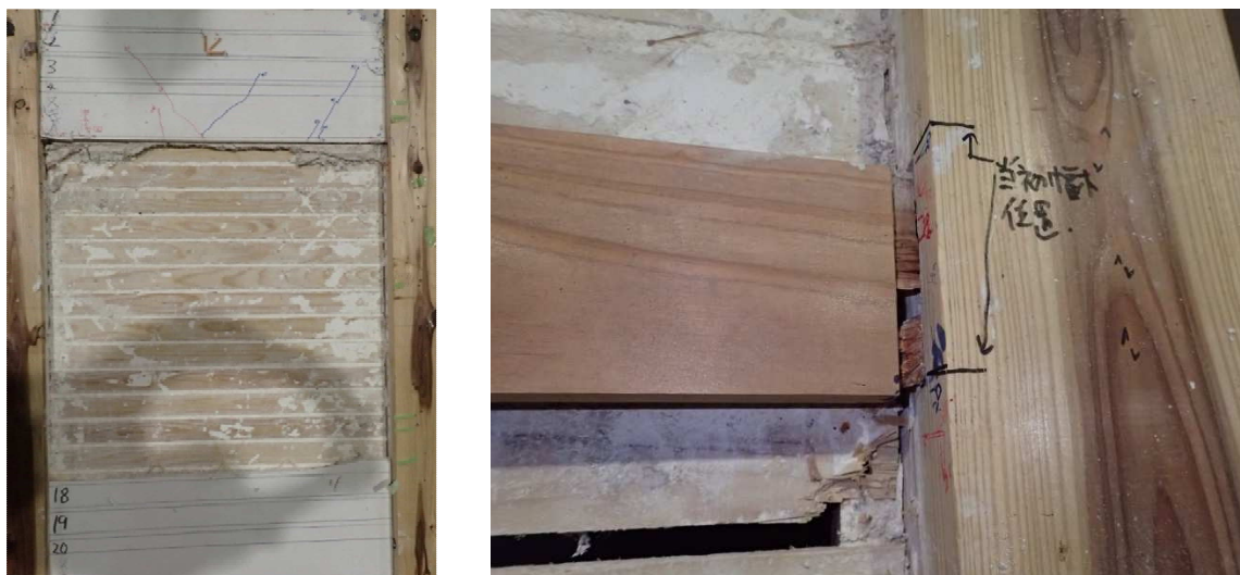
図 4-113 左図：解体後の漆喰破壊状況 右図：鴨居下，幅木右端部の破壊状況
