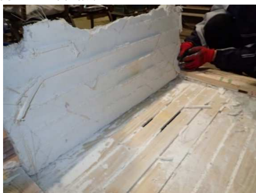
図 4-105 解体後 漆喰付着状況〔中心部は漆喰が切れず残存〕
