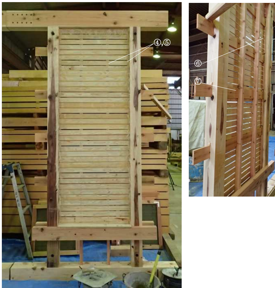
図 4-97 木摺漆喰壁試験体の木摺，木摺取り付け部材の抵抗部位
