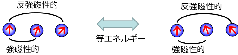
図 2.6. フラストレーションによって起こるらせん磁気構造
