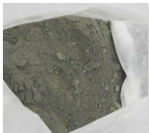
図5-11 転炉スラグの外観写真
