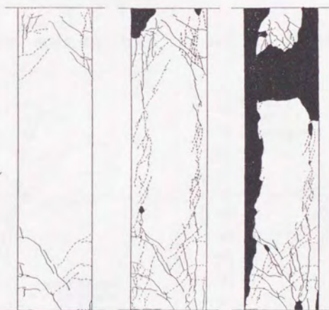
部材角 1/100 部材角 1/50 部材角 1/25 図 4.12 (F) ひび割れ図 (試験体 C 6)
