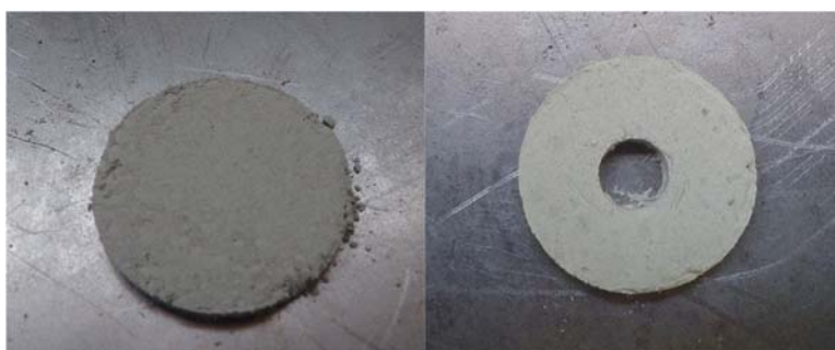
図 3-1 測定用試料（左：誘電率測定用，右：透磁率測定用）
