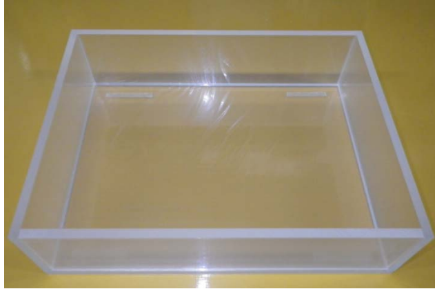
図 6-7 アクリル板で作成した型枠
