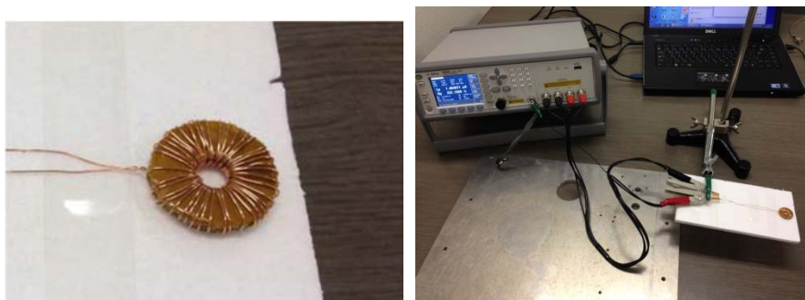
図 3-3 複素透磁率の測定試料と測定状況 (左：ベントナイトのトロイダルコア，右：測定状況)
