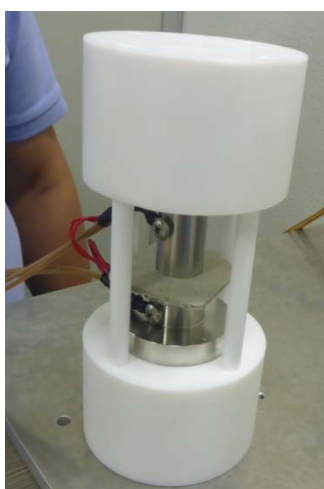
図 3-2 複素誘電率の測定状況
