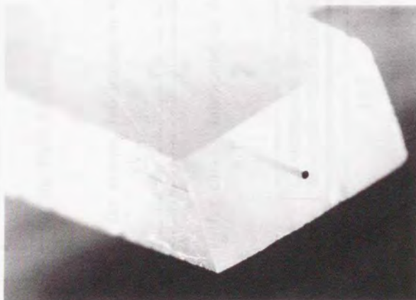
図3.10 アルゴンガス中作製材の引張り速度 1.67 \times 10^{-3} \text{m/s} での単繊維引抜き試験後の試験片。
