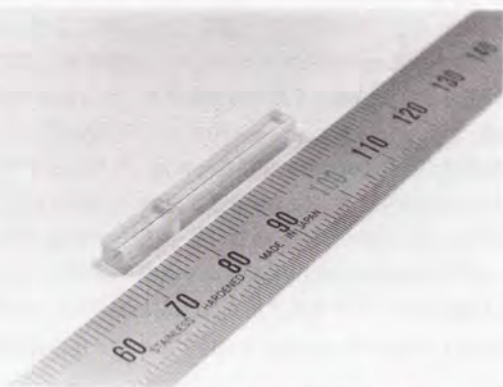
図3.3 界面特性評価に用いた単繊維引抜き試験片。
