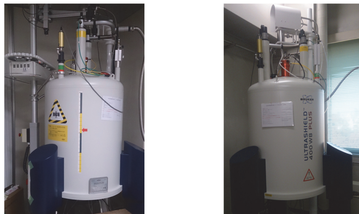
Figure 3. 溶液 NMR 装置(左)と固体 NMR 装置(右).
