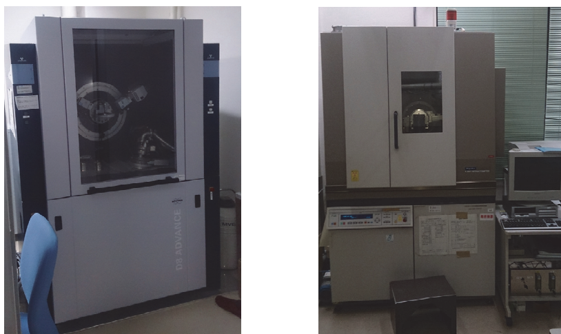
Figure 10. 集中型光学系(左)と平行型光学系(右).
