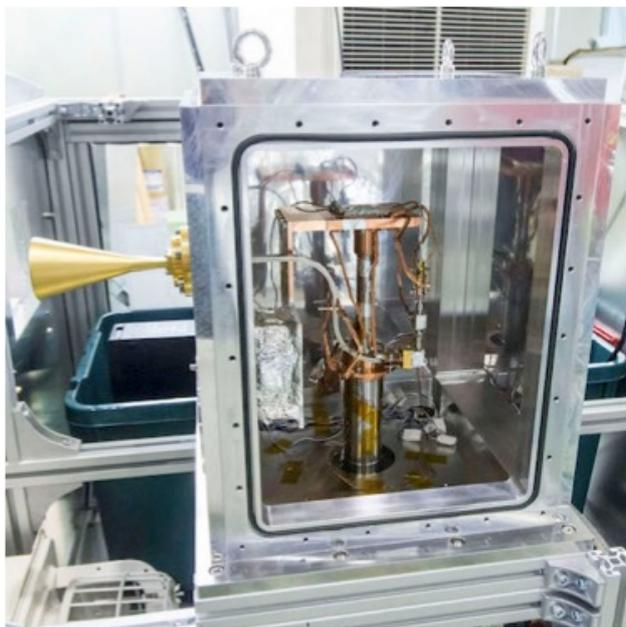
図1. 測定に用いたアンテナと低温検出器
