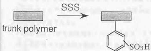
Fig. 1-2. 放射線グラフト重合法によるスルホン酸基の導入法
