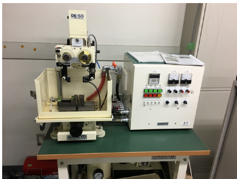
Fig. 2.2: 試料の加工に用いた三協エンジニアリング社製の放電加工機
