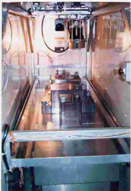
校正用ファントム測定時の状況
