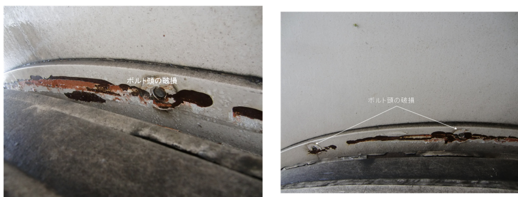
図 1.12 タワーリンクのボルト破断
