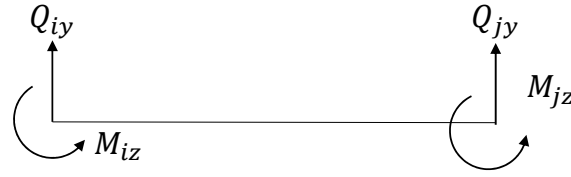
(a) xy 平面上の曲げモーメントとせん断力の方向
