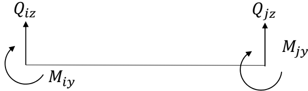
(b) xz 平面上の曲げモーメントとせん断力の方向
