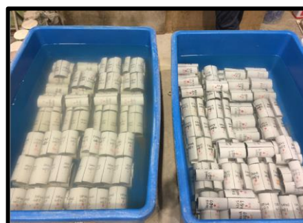
図 2.4 室内塩水浸せき試験状況
