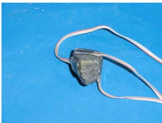
写真 3.2-3 骨材粒子の収縮ひずみ測定の一例
