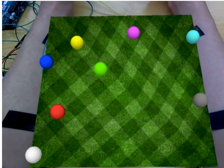
図 5.2 テーブルトップ型視触覚ディスプレイの例
