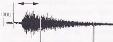
Fig.3-1-3 隕石衝突の相対パワースペクトル。波形図に示した21.64min.のパワースペクトルをその直前21.64min.のパワースペクトルで規格化したもの。'70年98日、アポロ12-site(LPX)。
