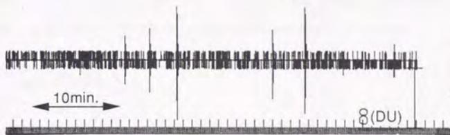
Fig.4-16 アポロ月震データのノイズのひとつ。月レゴリスの熱膨張、収縮のため月震計がわずかに傾くことが原因とされている(NASA; SP235)。本文中のtilt noise。
