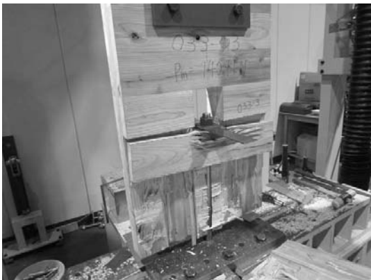
写真 6.4-35 033-3 積層接着面のせん断木部破壊
