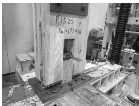
写真 5.4-21 Mx60APS1520-1 座金下部 両脇の積層接着面のせん断木部破壊
