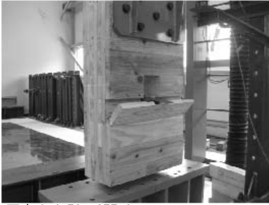
写真 6.4-73 077-3 積層接着面のせん断木部破壊
