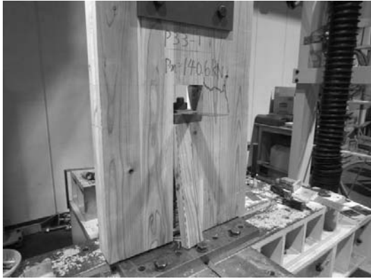
写真 6.4-1 P33-1 外層ラミナ中央部の割れ→ 積層接着面のせん断木部破壊、引張破壊
