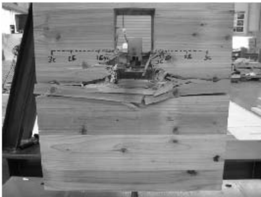
写真 6.4-57 055D-1 積層接着面のせん断木部破壊
