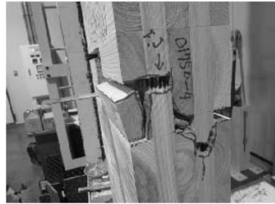
写真 5.4-62 Mx60AOS1750-4 引張破壊 (FJ)
