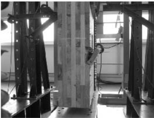
写真 6.4-71 077-2 積層接着面のせん断木部破壊
