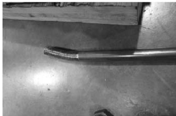
写真 4.4-28 ボルトの曲がり
