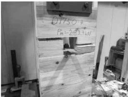
写真 5.4-61 Mx60AOS1750-4 引張破壊
