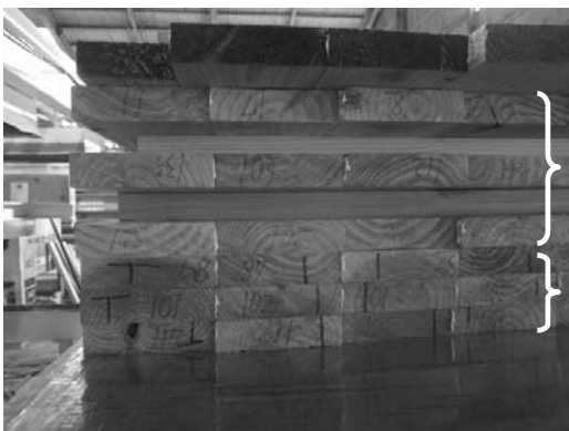
写真 3.3-5 養生 ナンバリングにより ラミナの配置を管理している。
