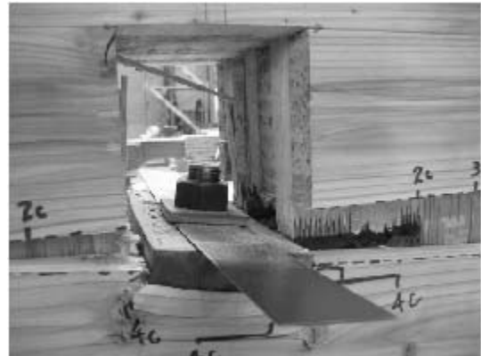
写真 6.4-76 077-6 引張破壊 (FJ)
