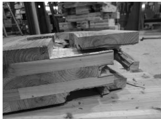
写真 5.4-12 S30AOC1515-2 積層接着面のせん断木部破壊
