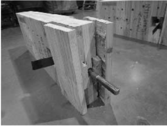
写真 5.4-47 Mx60AOS1520-1 積層接着面のせん断木部破壊
