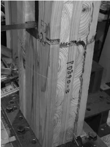
写真 5.4-19 Mx60APS 0840-3 引張破壊 (FJ) とせん断の複合的破壊
