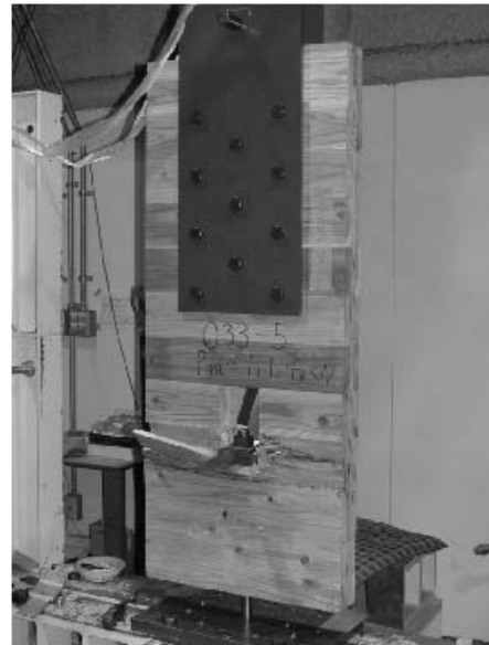
写真 6.4-40 033-5 積層接着面のせん断木部破壊
