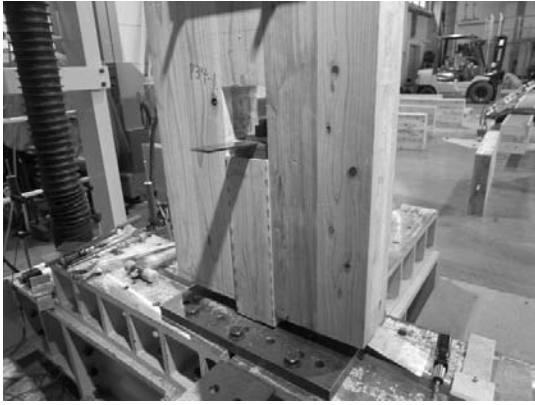
写真 6.4-7 P34-1 積層接着面のせん断木部破壊
