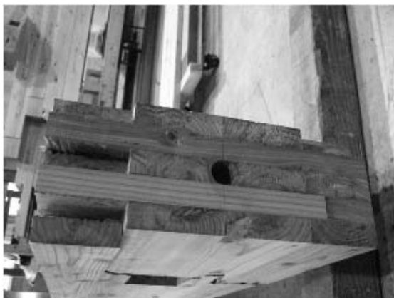
写真 5.4-3 60SPC1530-1 積層方向のせん断 木部破壊と引張断面の複合破壊
