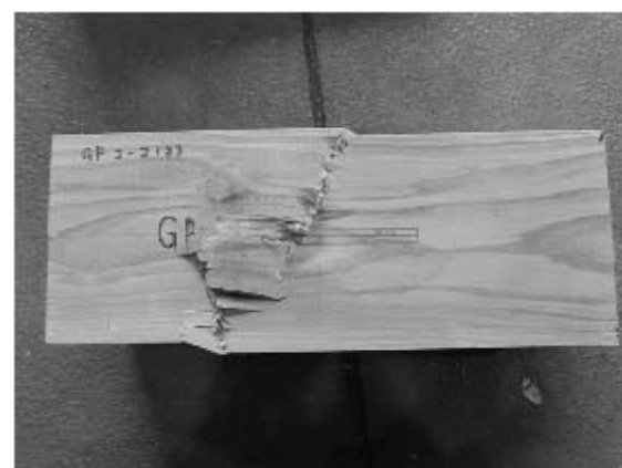
写真 3.7-10 GP200 座屈のような破壊
