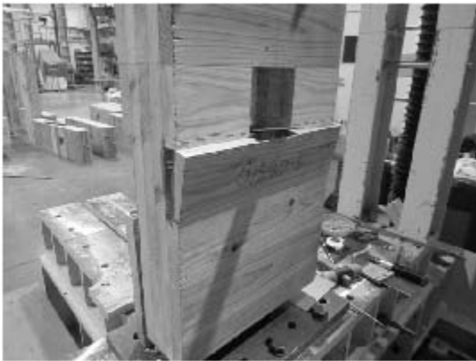
写真 5.4-55 Mx60AOS1540-3 積層接着面 のせん断木部破壊
