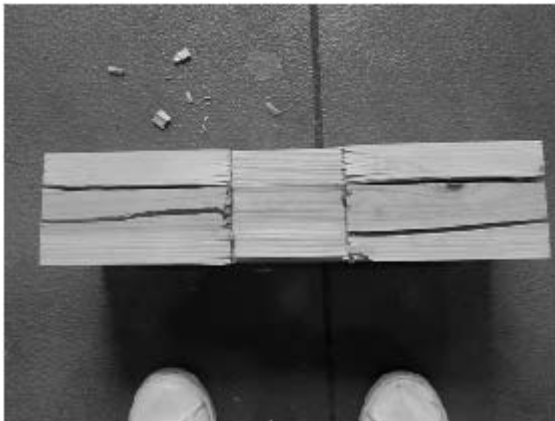
写真 3.7-13 GO 割裂破壊
