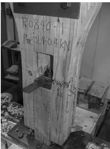
写真 5.4-13 S30AOC1550-1 引張破断
