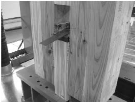
写真 6.4-25 P77-1 積層接着面のせん断木部破壊
