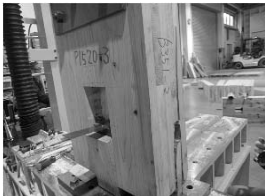
写真 5.4-26 Mx60APS1520-3 座金下部→ 両脇の積層接着面のせん断木部破壊
