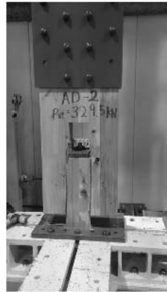
写真 4.4-13 Mx60A-2 積層接着面のせん断木部 破壊
