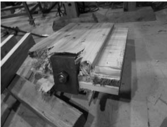
写真 5.4-9 S30APC1550-3 引張とせん断 の複合破壊 (接着不良)
