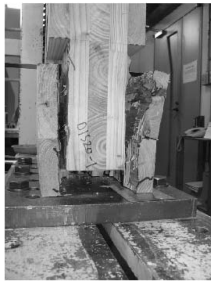
写真 5.4-46 Mx60AOS1520-1 積層 接着面のせん断木部破壊
