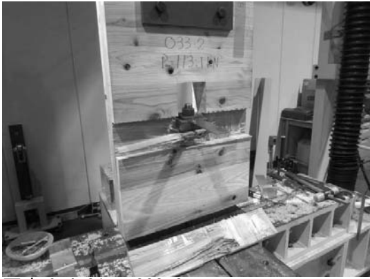
写真 6.4-31 033-2 積層接着面のせん断木部破壊
