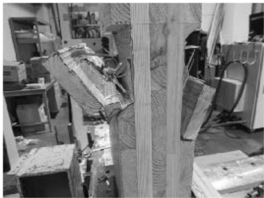
写真 5.4-58 Mx60AOS1750-1 積層接着面 のせん断木部破壊
