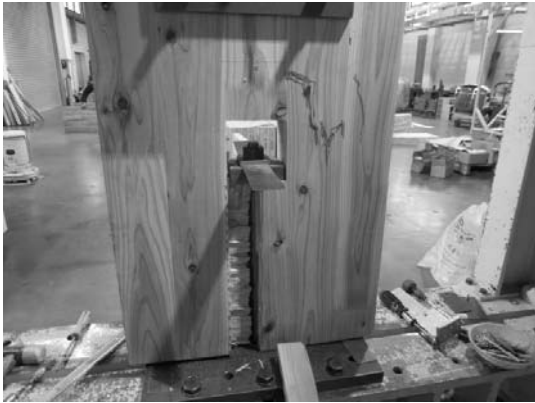
写真 6.4-3 P33-2 外層ラミナ中央部の割れ→ 積層接着面のせん断木部破壊、引張破壊
