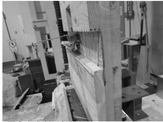
写真 6.4-32 033-2 積層接着面のせん断木部破壊
