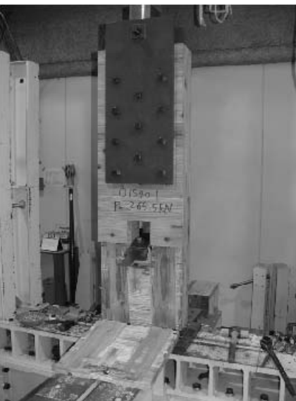
写真 5.4-51 Mx60AOS1540-1 積層接着面のせん断木部破壊
