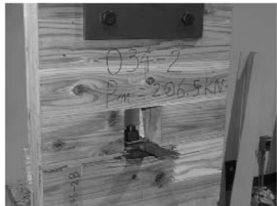
写真 6.4-46 034-2 積層接着面のせん断木部破壊
