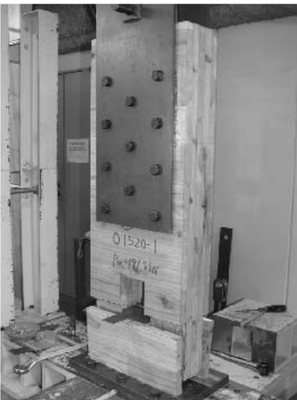
写真 5.4-45 Mx60AOS1520-1 積層 接着面のせん断木部破壊
