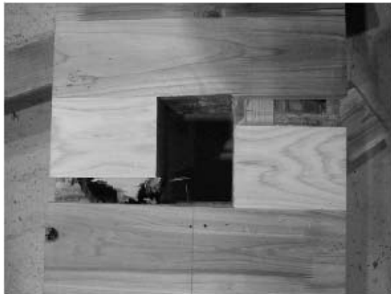
写真 5.4-13 S30AOC1550-1 引張破断
