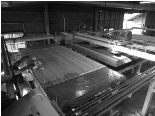
写真 3.3-3 積層接着 接着材の塗布
