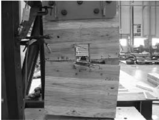
写真 6.4-75 077-6 引張破壊 (FJ)
