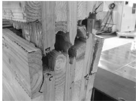
写真 6.4-78 077-6 引張破壊 (FJ)
