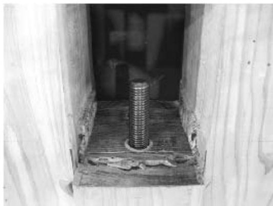
写真 6. 4-23 P55D-4 座金下部のめり込み
