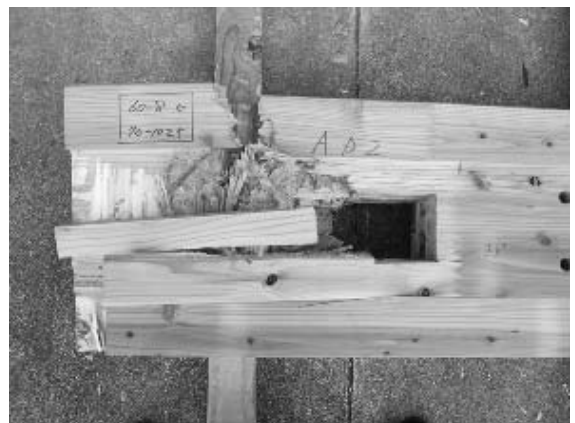
写真 4.4-10 S30B-2 積層接着面のせん断 木部破壊
