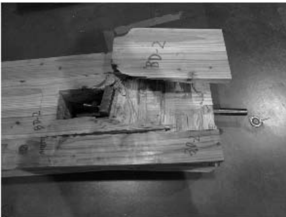
写真 4.4-14 Mx60A'-2 積層接着面のせん 断木部破壊
