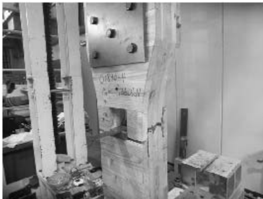
写真 5. 4-39 Mx60AOS0840-1 引張とせん断の複合的な破壊
