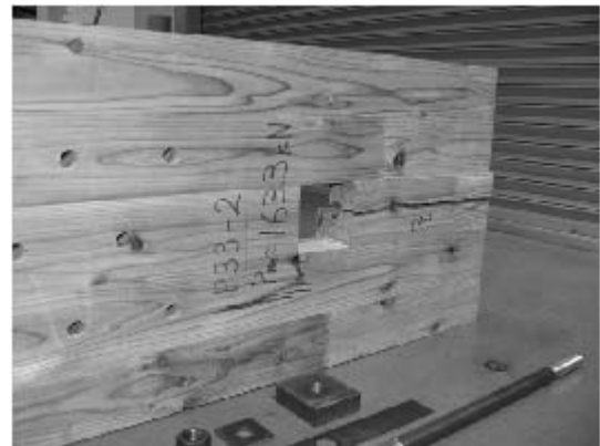
写真 6.4-4 P33-2 外層ラミナ中央部の割れ→ 積層接着面のせん断木部破壊、引張破壊
