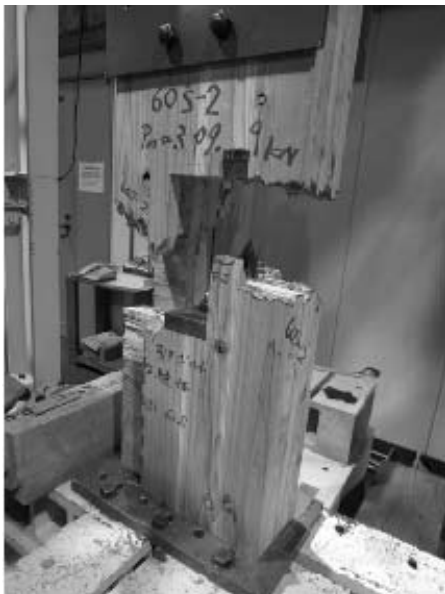
写真 4.4-22 60S-2 積層接着面の引張とせん断木部の複合的破壊
