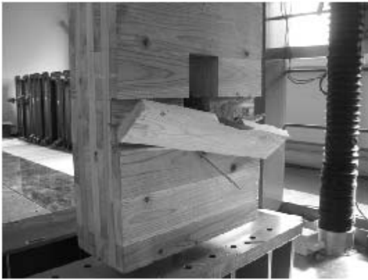
写真 6.4-67 077-1 積層接着面のせん断木部破壊
