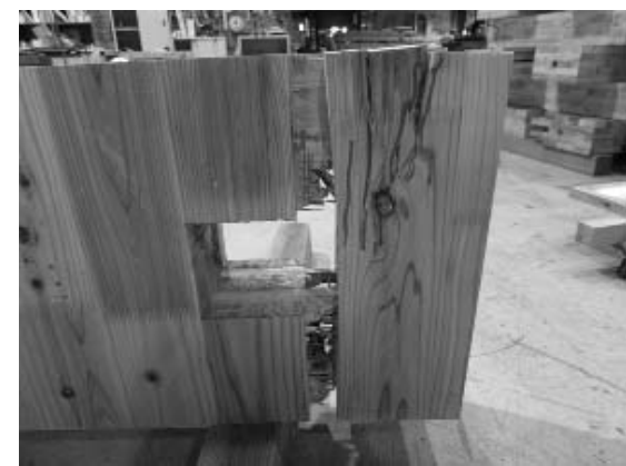
写真 5.4-10 S30AOC1515-1 積層接着面 のせん断木部破壊
