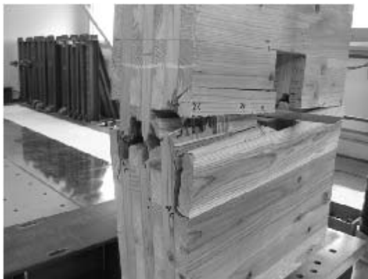
写真 6.4-77 077-6 引張破壊 (FJ)
