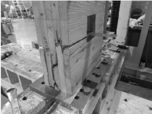
写真 5.4-49 Mx60AOS1520-2 引張と座金下部両脇せん断の複合的な破壊
