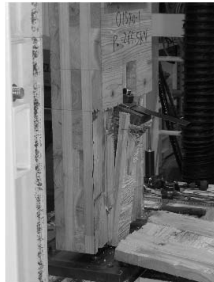
写真 5.4-52 Mx60AOS1540-1 積層接着面のせん断木部破壊
