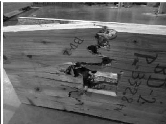
写真 4.4-15 Mx60A'-2 積層接着面のせん断 木部と引張の複合的破壊
