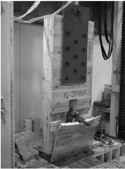
写真 6.4-49 055-1 積層接着面のせん断木部破壊
