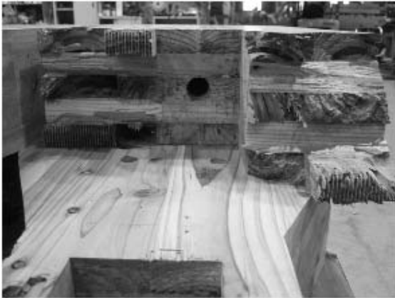
写真 5.4-5 60SPC1550-1 引張破断の断面
