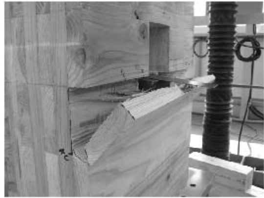
写真 6.4-74 077-3 積層接着面のせん断木部破壊
