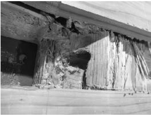
写真 5. 4-37 Mx60APS 1750-5 解体後 座金下部のめり込み
