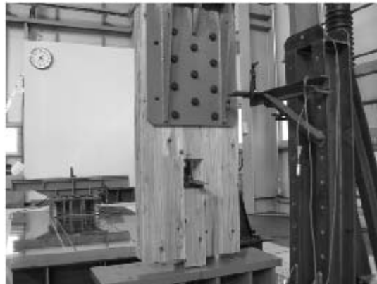
写真 6. 4-24 P55D-5 積層接着面のせん断木部破壊
