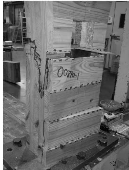
写真 5. 4-40 Mx60AOS0840-1 引張とせん断の複合的な破壊
