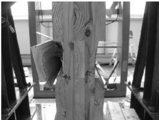
写真 6.4-65 055D-5 積層接着面のせん断木部破壊
