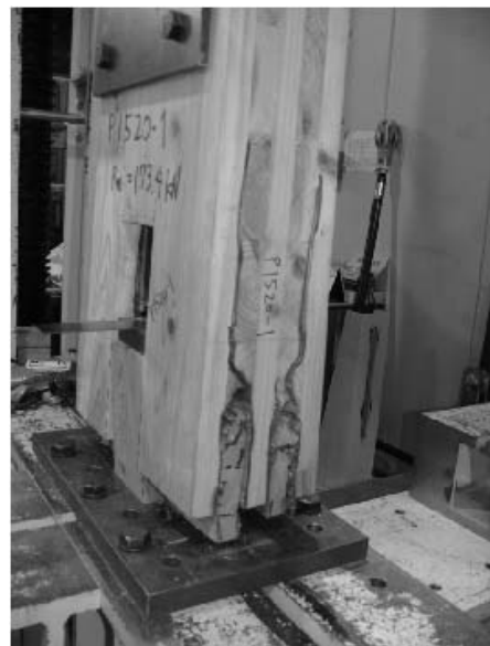
写真 5.4-22 Mx60APS1520-1 座金下部両脇 の積層接着面のせん断木部破壊
