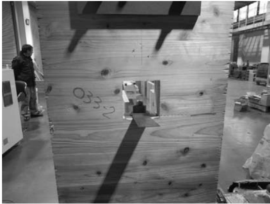
写真 6.4-33 033-2 積層接着面のせん断木部破壊
