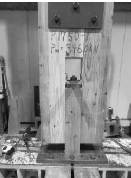
写真 5. 4-33 Mx60APS1750-1 積層接着面 のせん断木部破壊
