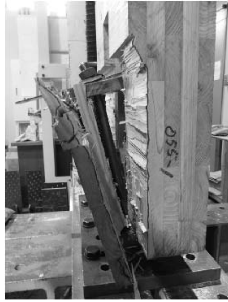
写真 6.4-50 055-1 積層接着面のせん断木部破壊
