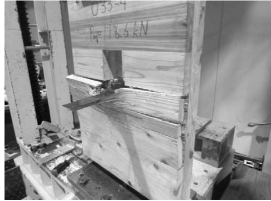
写真 6.4-38 033-4 積層接着面のせん断木部破壊
