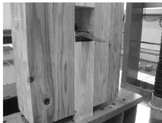
写真 6.4-29 P77-6 積層接着面のせん断木部破壊
