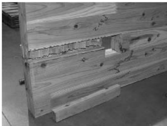
写真 6.4-5 P33-2 外層ラミナ中央部の割れ→ 積層接着面のせん断木部破壊、引張破壊
