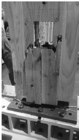
写真 4.4-12 Mx60A-1 積層接着面のせん断木部 破壊 (裏)
