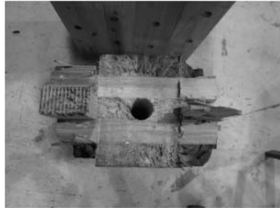
写真 5.4-6 S30APC0540-1 引張破断 (FJ 1箇所)
