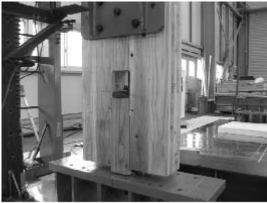
写真 6. 4-19 P55D-1 積層接着面のせん断木部破壊
