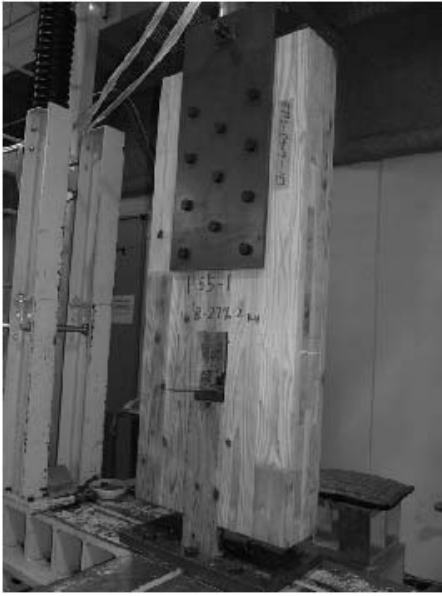
写真 6.4-13 P55-1 積層接着面のせん断木部破壊
