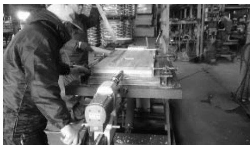
写真 4.2-2 ボルト孔加工の様子(広島河本組)
