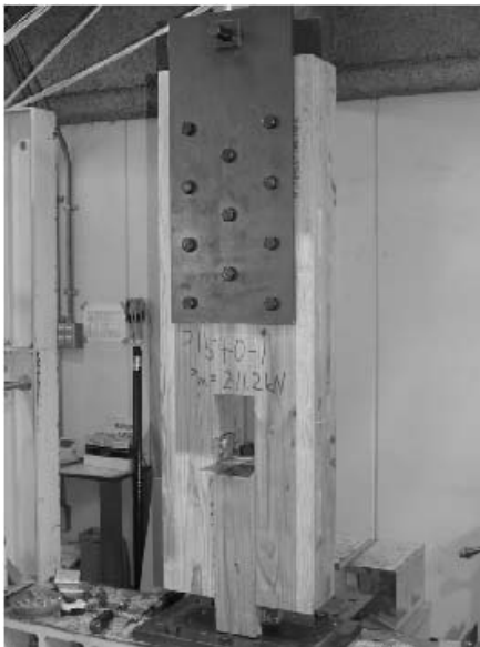
写真 5.4-27 Mx60APS1540-1 座金下部の積層接着面のせん断破壊
