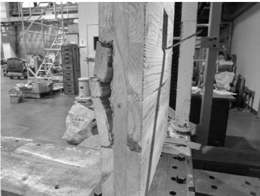
写真 6.4-39 033-4 積層接着面のせん断木部破壊
