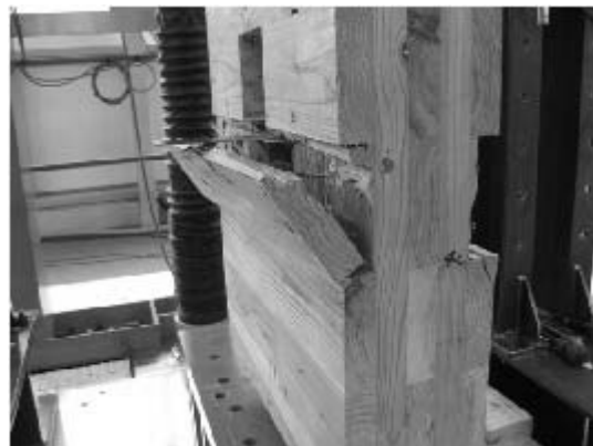
写真 6.4-66 055D-6 積層接着面のせん断木部破壊
