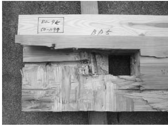
写真 4.4-17 Mx60B-5 積層接着面のせん断木部と引張の複合的破壊
