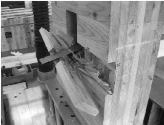
写真 6.4-69 077-1 積層接着面のせん断木部破壊
