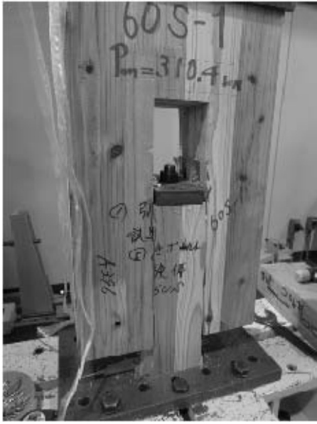
写真 4.4-20 60S-1 積層接着面のせん断木部破壊
