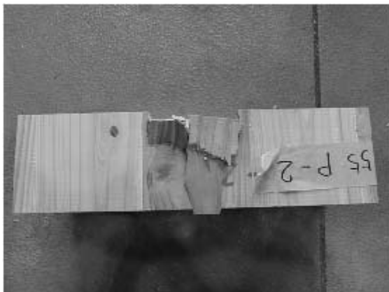
写真 3.7-21 CP55 外層の座屈
