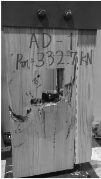
写真 4.4-11 Mx60A-1 積層接着面のせん断と 引張 (FJ) の複合的破壊 (表)
