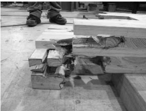
写真 5.4-7 S30APC1515-3 積層接着面の せん断木部破壊
