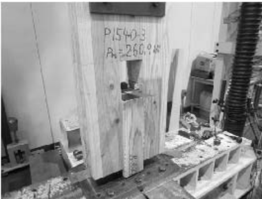
写真 5. 4-31 Mx60APS1540-3 積層接着面 のせん断木部破壊
