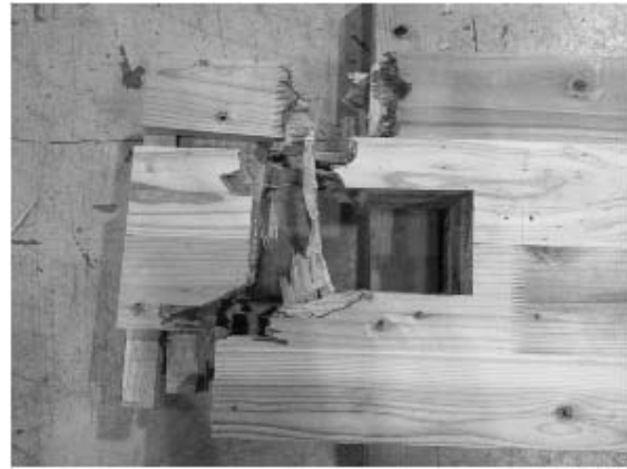
写真 5.4-8 S30APC1515-3 引張とせん断 の複合破壊
