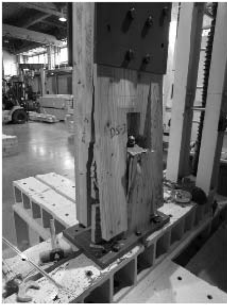
写真 4.4-24 DS-2 積層接着面のせん断 木部破壊
