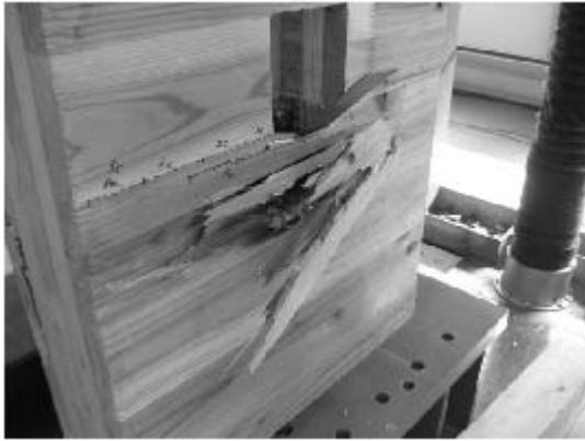
写真 6.4-61 055D-4 積層接着面のせん断木部破壊
