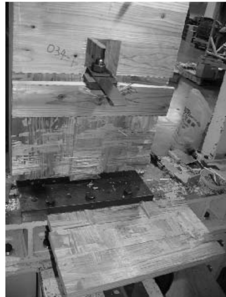
写真 6.4-44 034-1 裏面損傷無し
