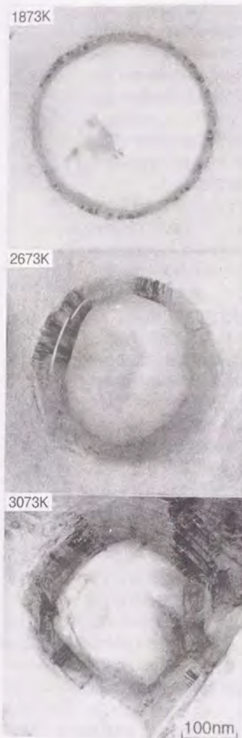
図 4. 2: 熱処理温度の変化にともなうマトリックス中のポア構造の変化
