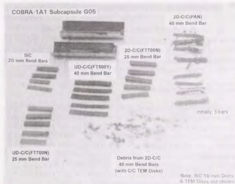
図 6. 12: C/C 複合材料の高照射量での寸法、形状変化
