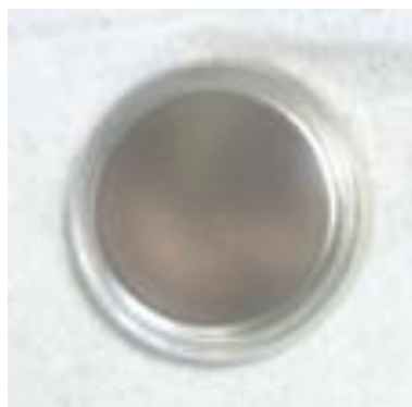
図 2-2 充放電試験で用いた 2032 型コインセル
