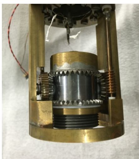
図 3.5 二軸回転機構に取り付けた圧力セル。
