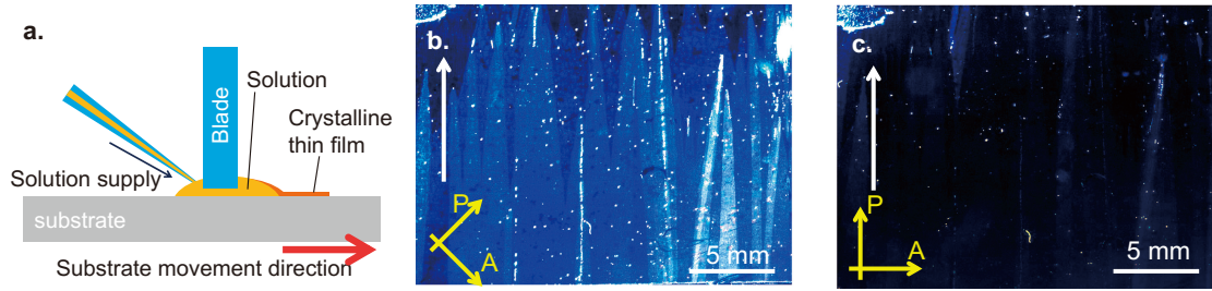
図 4.9 添田らによって報告された連続エッジキャスト法による大面積単結晶の作製 [46]。a、連続エッジキャストの模式図。b、対角位及び c、消光位における、C 10 -DNBDT-NW 大面積単結晶の偏光顕微鏡像（クロスニコル反射像）。
