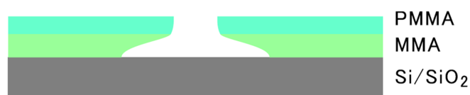
図 3.2. MMA/PMMA2 層レジストの現像後の模式図 87 。図のようなアンダーカット構造を実現することで、清純な金属端面を得ることができる。
