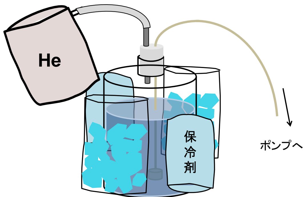
図 2-2 ショット瓶の周囲の冷却方法
