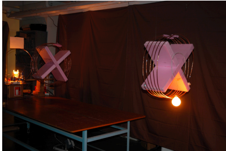
図 1.5: 2007 年に提案された磁界共振結合型無線電力伝送 [5]
