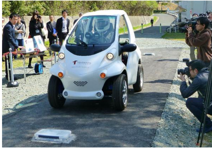
図 1.6: 地中から電気自動車への電界共振結合型無線電力伝送 [6]
