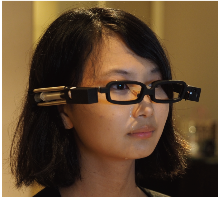
図5.3 擬似的な落涙を体験化する装置「涙眼鏡」
