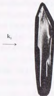
(c) 試料C-aの全面照射ロッキングカーブ ピーク位置でのトポグラフ (+, -) 平行配置の二結晶法による ^{57}\text{FeBO}_3 (444) のトポグラフ. 対称ブラッグケース.
