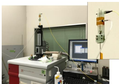
図 4.16 : MPMS での FBG スペクトル測定のプロープ
