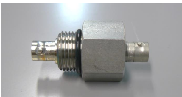
図 3-19. テクサム製 BNC 導入端子.
