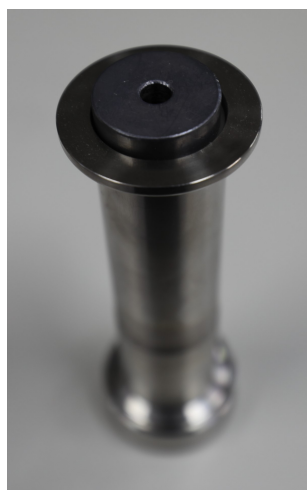
図.4.19: NW25 のフランジにはめ合わせた鉛コリメータ.
