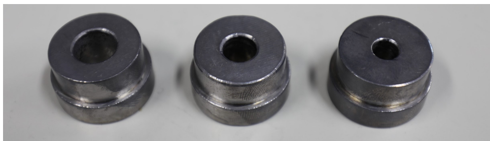
図.4.18: X線遮蔽のための鉛コリメータ (左から \phi 10 , \phi 8 , \phi 6 ).
