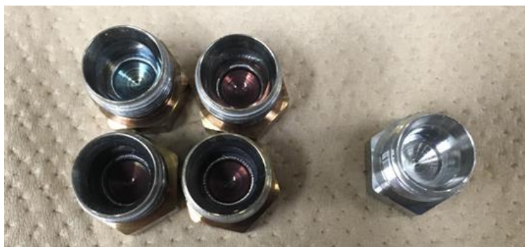
Fig 2.5 反応器キャップ内部の色の変化 左: 前処理後、右: 未処理
