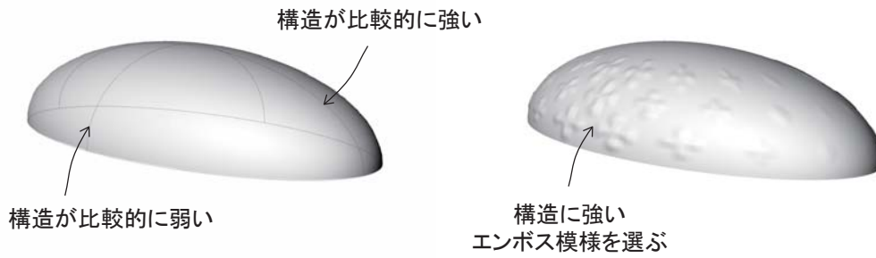
図 1.3 エンボスを施すことで構造を強くする
