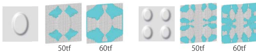
図 4.14 模様を縮小して並べる場合の塑性ヒンジ図
