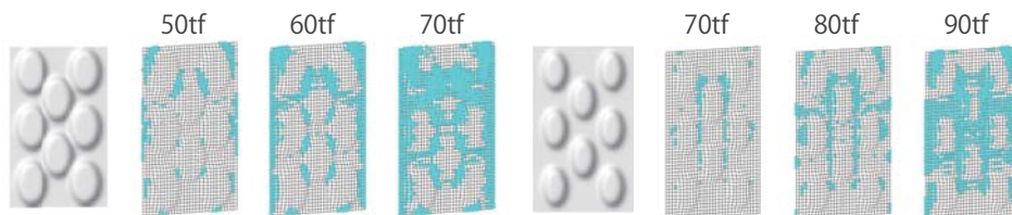
図 3.14 模様を大きくする場合の塑性ヒンジ図
