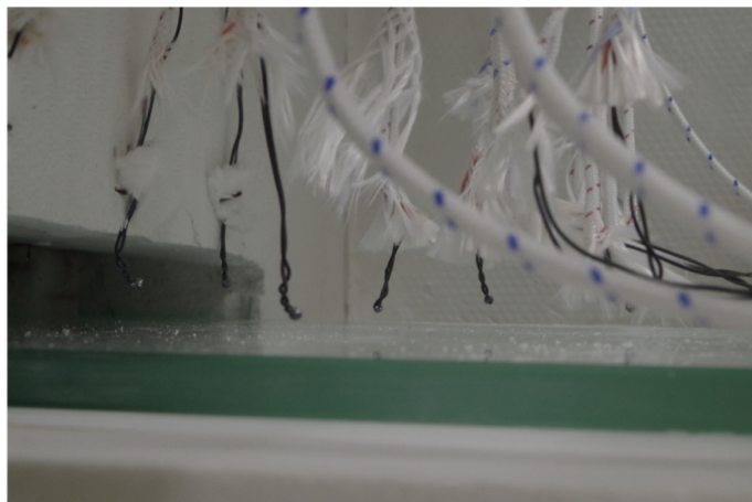
図 3.5 熱電対設置の様子
