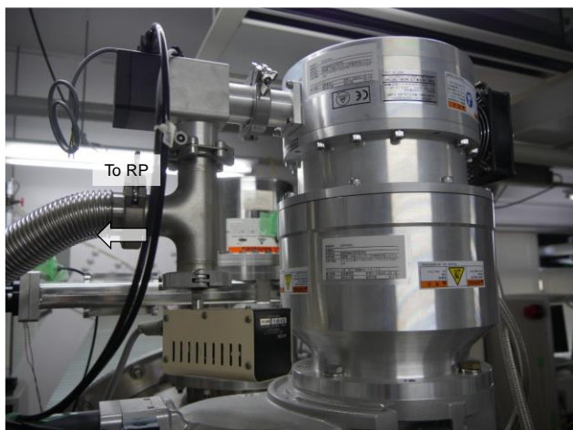
図 3-9 大阪真空社製ターボ分子ポンプ (TG900MVAB)
