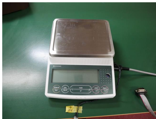
図 2-17 島津社製電子天秤 (BL-3200H)
