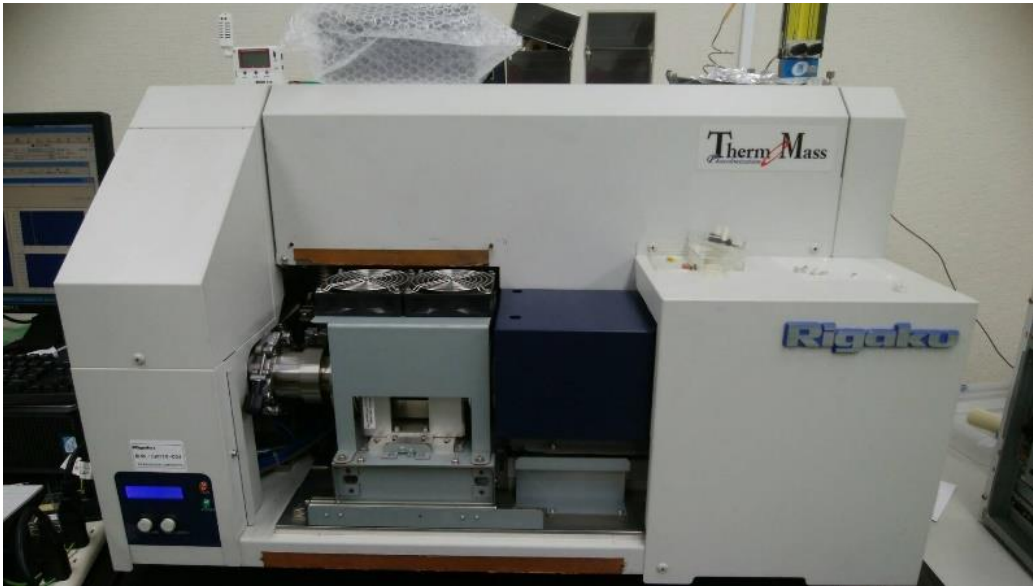
Figure 8 示差熱天秤－光イオン化質量分析同時測定装置 Thermo Mass Photo(Rigaku)
