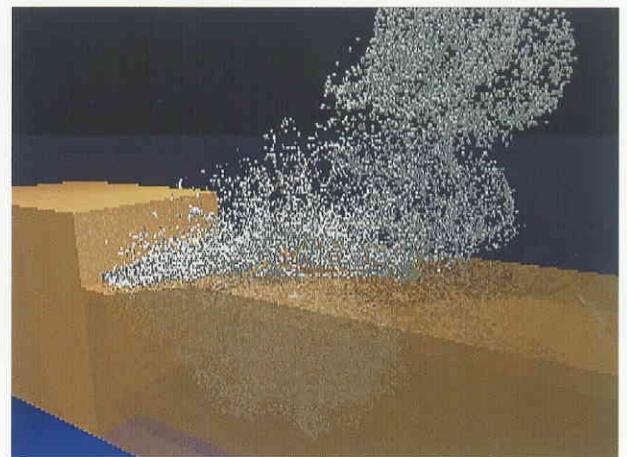
口絵4 パイプオルガンの空気流解析のパーティクルトレース表示
