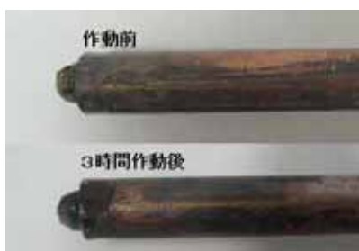
第5図 使用前及び3時間作動後の陰極写真
