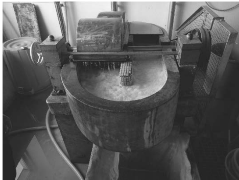
写真6 ビーターに紙料を投入したところ
