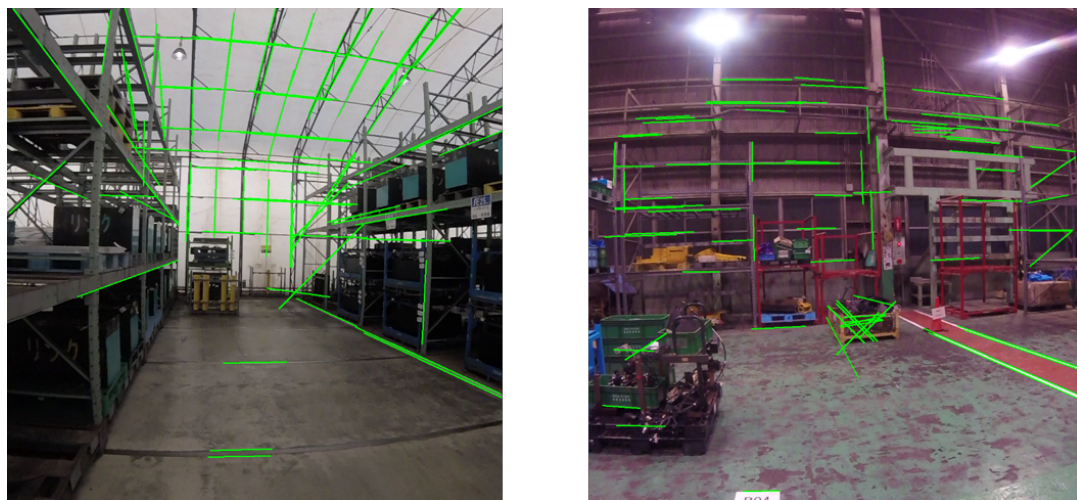
図 4.2 工場内の棚に対するハフ変換による直線抽出
