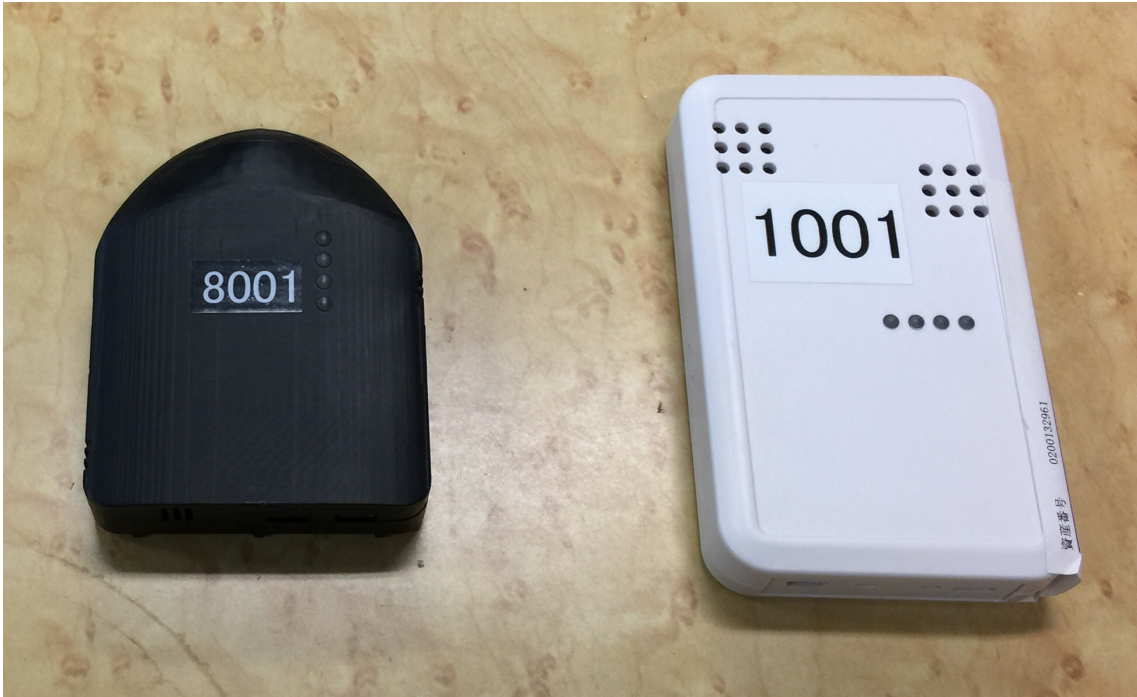
図 4.2 UWB 測位システムで用いる移動機（左）と親機（右） [5]
