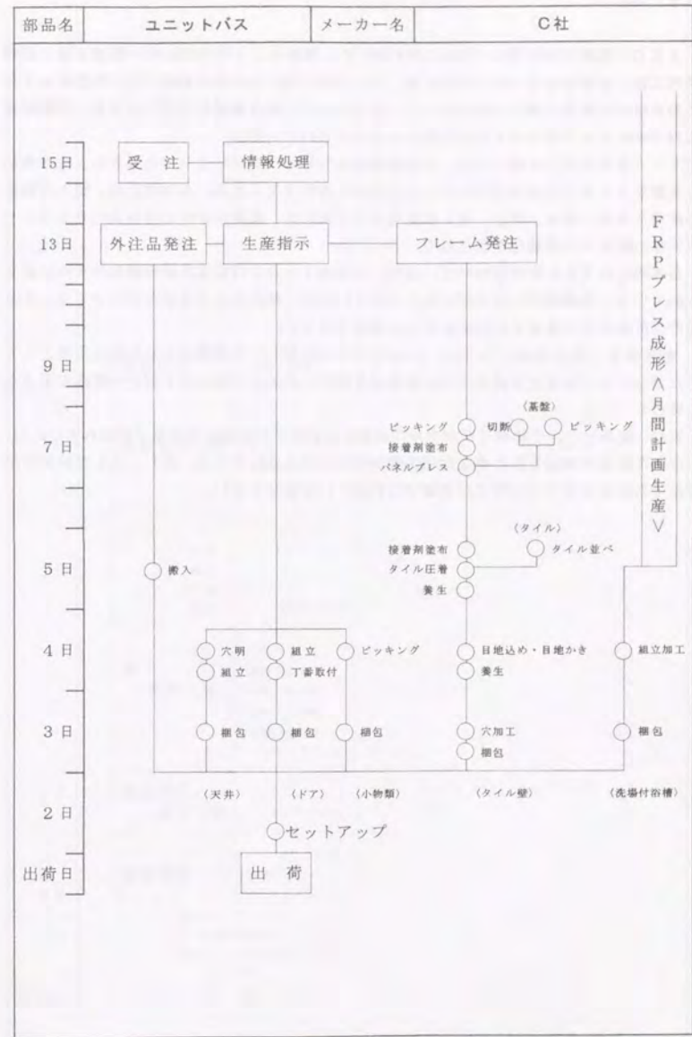
図3-7 (4) ユニットバスの製造工程
