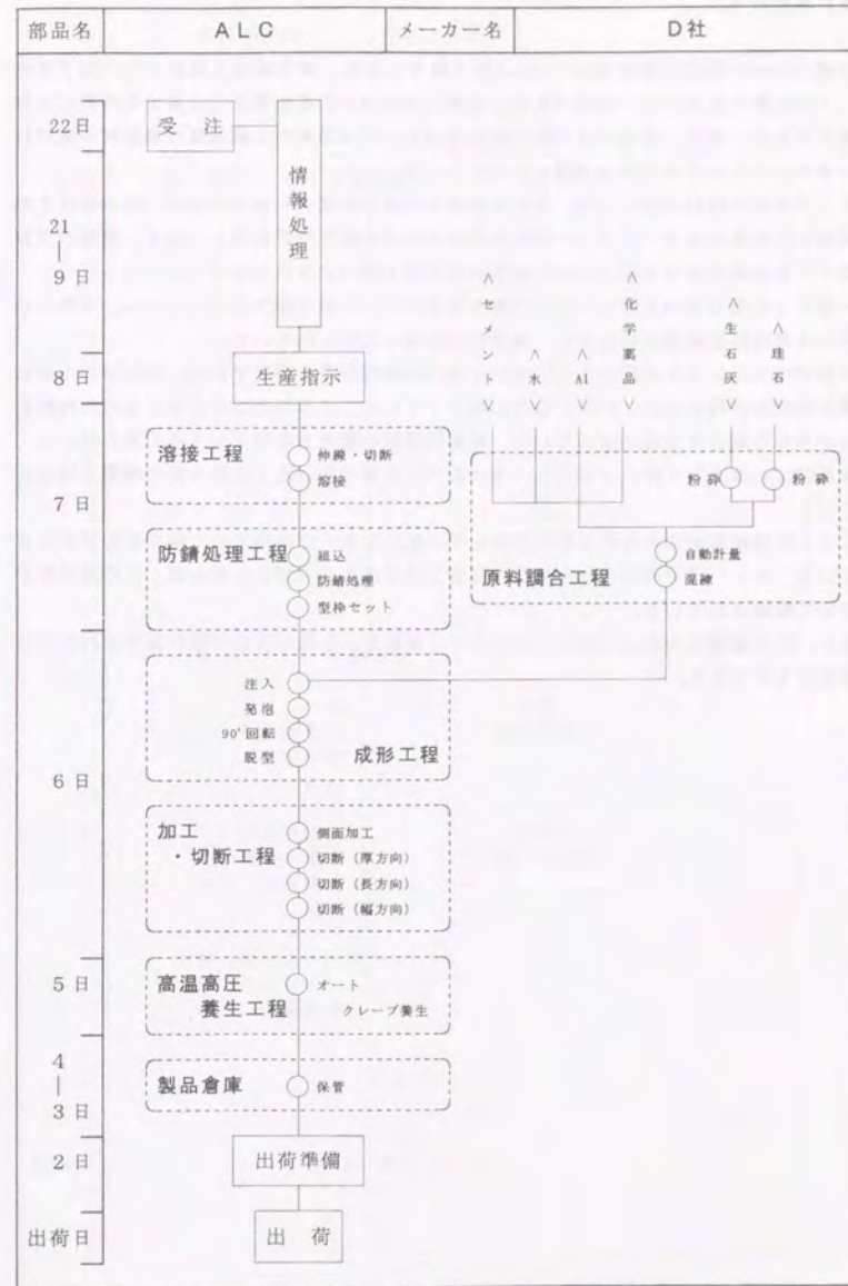
図3-7 (5) ALCの製造工程
