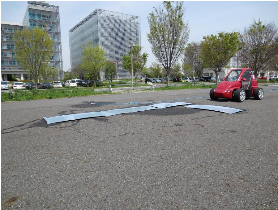
Fig. 36: 実験概要図：FPEV-2 Kanon を用いた片輪着陸時におけるヨーレート抑制制御
