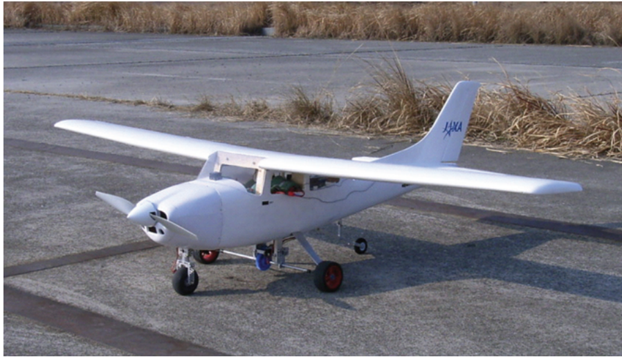
Fig. 9: JAXA : 駆動輪を搭載した小型模型飛行機 [28]
